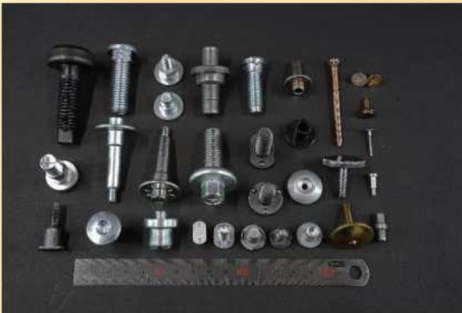
※2D3B ヘッダー成型、2D3B ヘッダー+フォームローリング、二次加工
