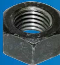
鉄鋼材料の表面を覆っている酸化皮膜の事。鉄鋼が真っ赤に焼けた状態で空气中に晒され続けた結果、鉄鋼表面に黒ずんだ酸化鉄が発生します。これを黒皮と呼んでいます。黒皮は空気中の酸素と反応して生じるもので、鉄鋼の表面にのみ生じ、内部に侵入する事はありません。鉄鋼の表面を覆う黒皮は、新品の鉄鋼の酸化を防ぐ皮膜としても機能しています。
