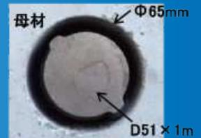
横向きに施工した D51x1m が「スペーサー機能」によって孔の中央に位置づけている様子
