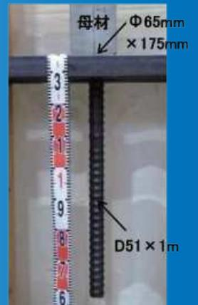
上向きに施工した D51x1m が「ストッパー機能」によって接着剤が無くてもずれない様子
