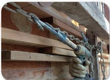
通常のターンバックルに比べ、約半分の時間で作業できます。手でしか回せなかったターンバックルを電動ドリルやインパクトドライバー、ラチェットレンチ等の工具で締め込み、取り外し作業ができます。また、チェーンを緩めずピンと張ったまま作業が出来ますので時間を大幅に短縮できます。
